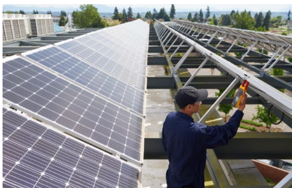
Přístroj Fluke 393 FC může měřit napětí, proud, stejnosměrný výkon a poskytovat zvukovou signalizaci nesprávné polaritě na fotovoltaických panelech.
