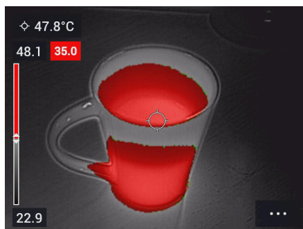
Alarm nad limitem: Zvýrazní všechny pixely, které mají vyšší teplotu než nastavená teplotní úroveň.
