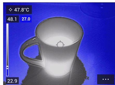
Alarm pod limitem: Zvýrazní všechny pixely, které mají nižší teplotu než nastavená teplotní úroveň.
