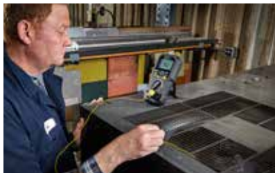
Včetně vstupu pro termočlánek typu K pro měření teploty
