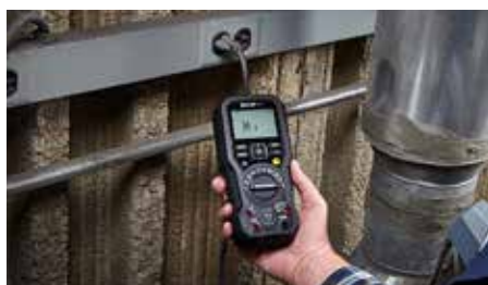
Kontrola přítomnosti napětí pomocí vestavěného bezdotykového detektoru napětí (NCV)
