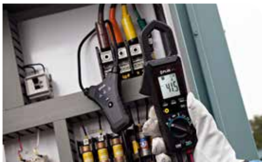
Snadné měření v nepřístupných místech s volitelnou flexibilní sondou TA74
