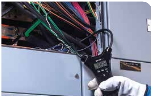
Flexibilní kabel ampérmetru FLIR CM57 garantuje pohodlné měření i ve stísněných místech
