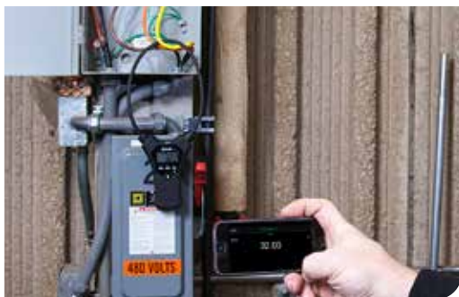
Funkce Bluetooth u modelu CM57 umožňuje odečet hodnot z bezpečné vzdálenosti
