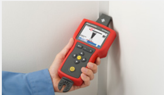
Hrotový snímač se používá pro vyhledávání vodičů v obtížně přístupných místech.
