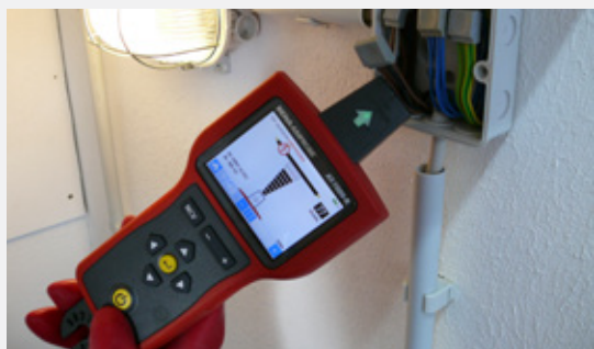
Napájené vodiče nebo vodiče odpojené od napětí se vyhledávají po sejmutí krytu svorkovnice.
