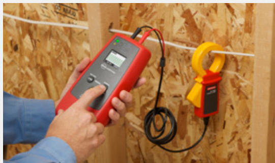
Signál indukovaný signálovými kleštěmi se používá, když není k dispozici obnažený vodič.
