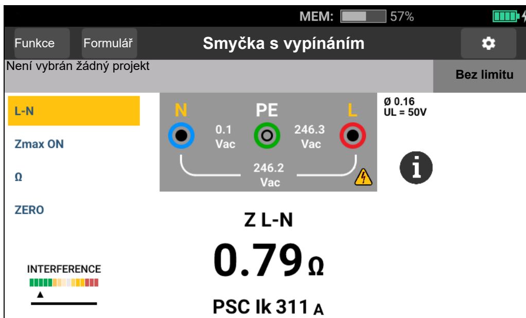
Obrázek 13. Obrázovka měření impedance sítě
