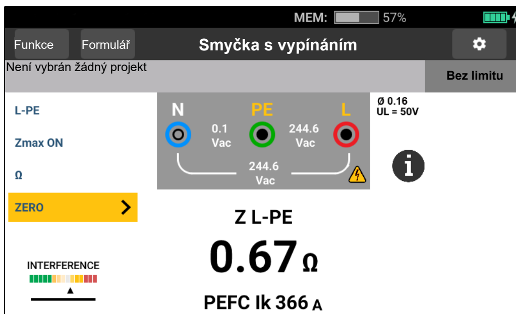
Obrázek 12. Obrazovka měření impedance smyčky s vypínáním
